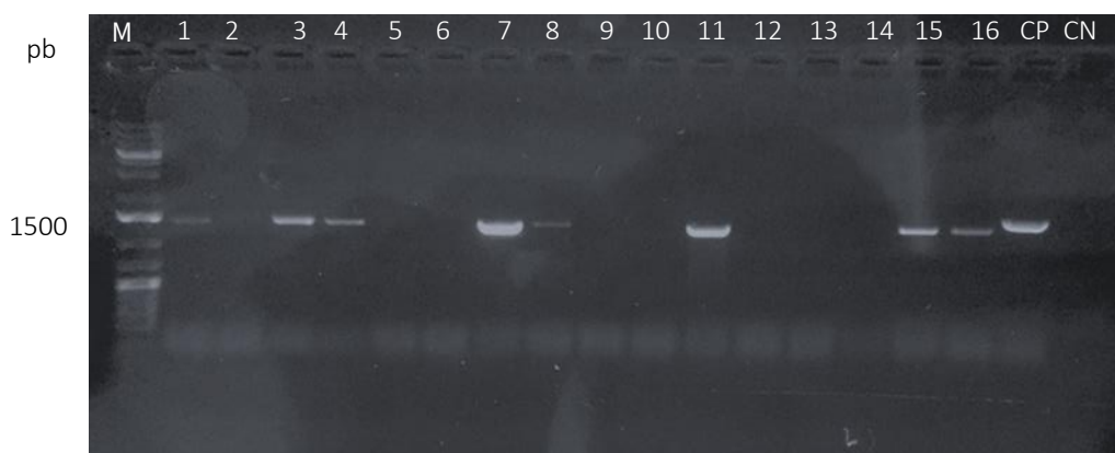
Figura 24 | Análise eletroforética em gel de agarose 1% de alguns dos produtos de DNA amplificados, com utilização dos primers \beta - Tubulina. Legenda: M- Marcador GeneRulerTM 1 kb PLUS 1- 17 amostras testadas (Anexo I); CN- Controlo negativo; CP- Controlo Positivo;
