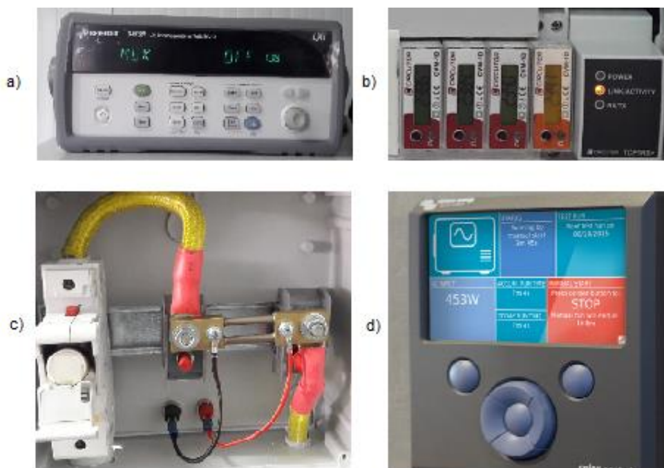
Figura 21. Equipamentos de aquisição, instrumentação e comunicação utilizados na instalação do sistema EES, no circuito de corrente alternada e circuito de corrente contínua. a) Datalogger ; b) Conversor TCP 1RS+ e analisador de rede CVM-1D; c) Resistência de precisão e fusível de proteção; d) Color Control GX .
