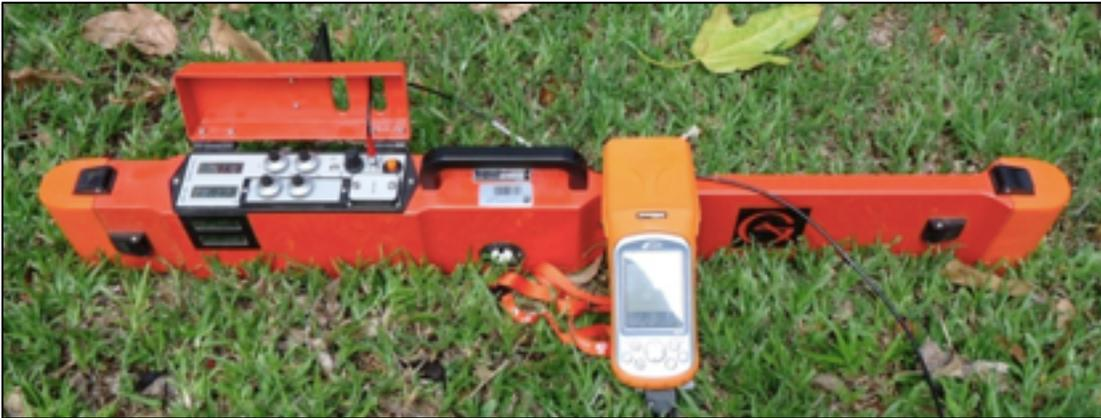
Figura 3.11. - Equipamento de prospeção eletromagnética de baixa frequência EM38-MK2 (retirado de Caldeira e Borges, 2015)
