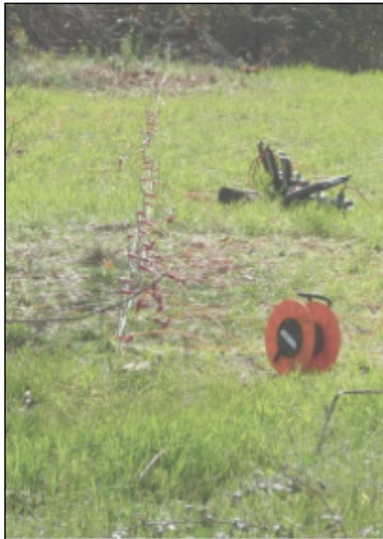
*Figura 3.5 - Equipamento de perfilhamento multieléctrodo em funcionamento na Cidade romana da Ammaia (retirado de Caldeira e Borges, 2015)*
