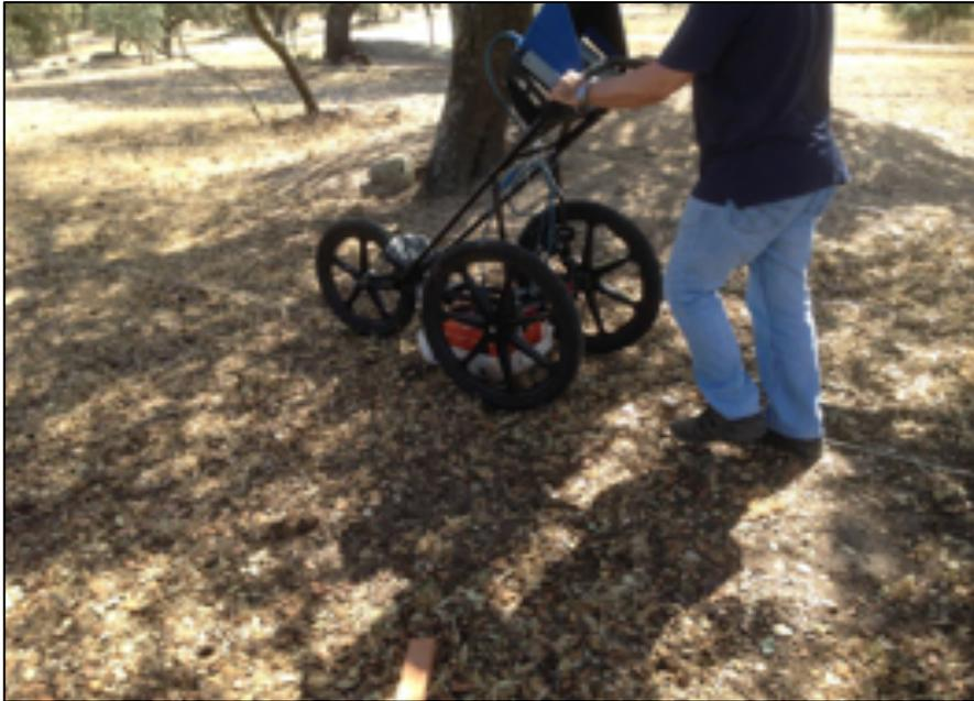
*Figura 3.1 - Recolha de dados em campo com GPR montado em kart. As antenas do dispositivo representado na figura encontram-se no interior da caixa cor de laranja colocada entre as rodas traseiras do kart.*
