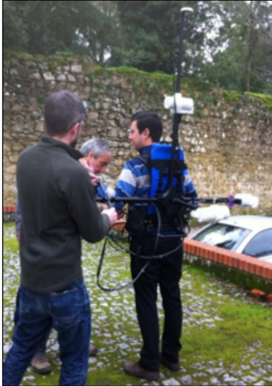
Figura 3.7 - Magnetómetro de alta precisão de protões, tipo overhouser do ICT (retirado de Caldeira e Borges, 2015)
