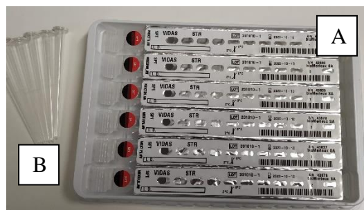
Figura 4. Componentes do kit de imunodeteção para Salmonella spp.: barrete de reagentes (A) e recipiente (B).
