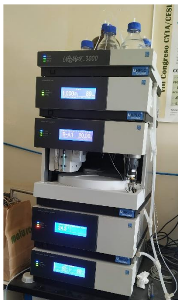
Figura 6. Equipamento utilizado para a separação e identificação das aminas biogénicas em estudo (UHPLC Ultimate 3000).
