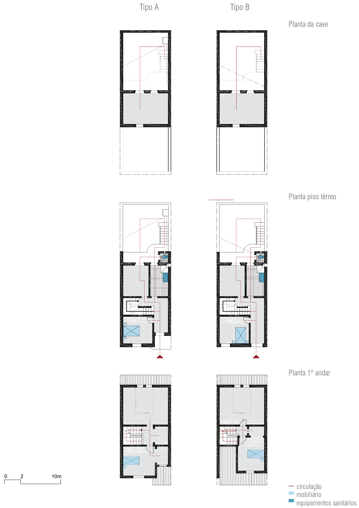
FIG.05.09 | Projecto dum grupo de dez habitações , Fogo tipologia A e B- circulação, mobiliário e equipamentos sanitários
