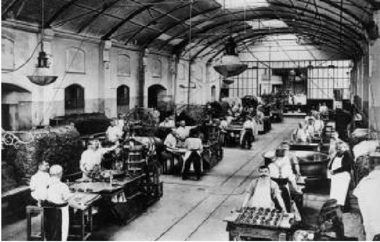
Fig. 1.8 Atelier de conchage et de dressage du chocolat. Source : Dossier « Les industriels chocolatiers Menier à Noisiel »
