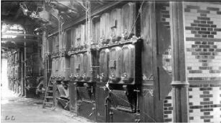
Fig. 1.4 Fours de torréfaction. Source : Dossier « Les industriels chocolatiers Menier à Noisiel »
