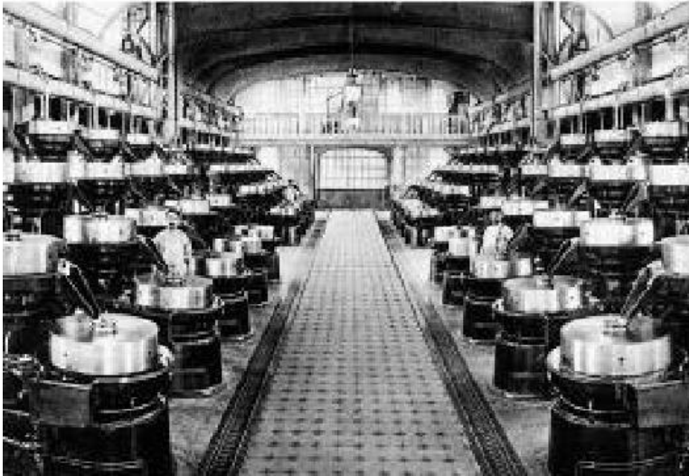
Fig. 1.6 Meules à broyer les fèves de cacao. Source : Dossier « Les industriels chocolatiers Menier à Noisiel »
