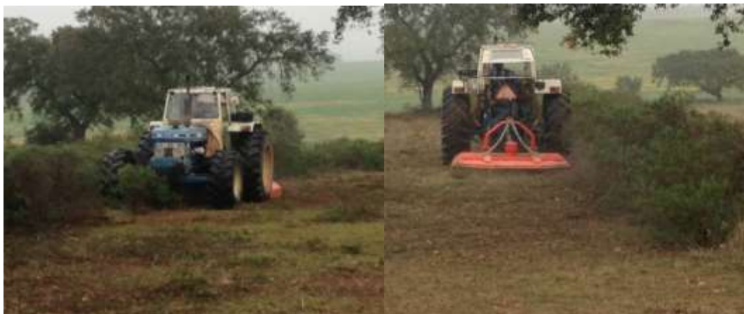
Fig. nº 13 - Corte mecânico da infestação arbustiva com corta mato após aplicação de herbicida
