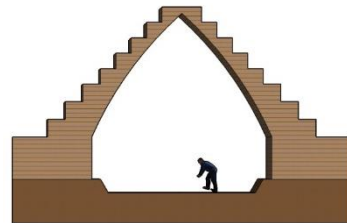
Figure 65: La construction du réservoir de glace,
