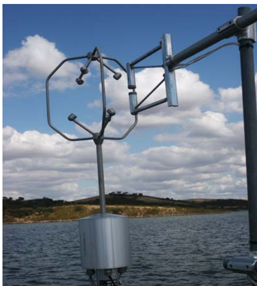
Figura 3.30 Posicionamento relativo dos sensores de vento e humidade.
