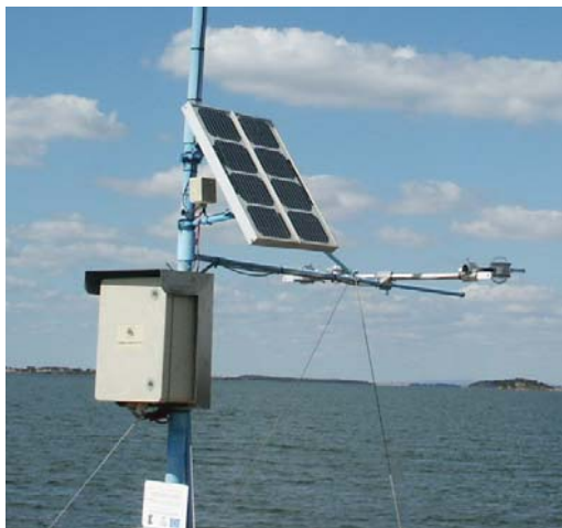
Figura 3.27 Sensores de radiação e respectivas estruturas de suporte e alimentação.
