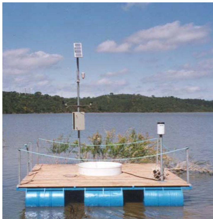
Figura 3.2 Estação meteorológica flutuante pronta a ser deslocada para a sua posição definitiva no interior da albufeira do Maranhão.
