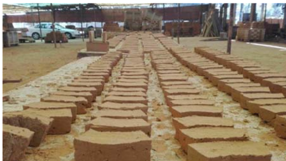
46. Briques produites de manière artisanale dans la briqueterie Cerâmica Tejo .
