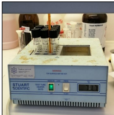
Figura 12 - Frascos em banho-maria de forma a promover o processo de saponificação. (Autoria própria)
