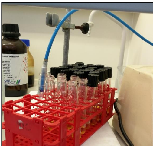
Figura 11 - Secura do solvente por meio de corrente de azoto. (Autoria própria)
