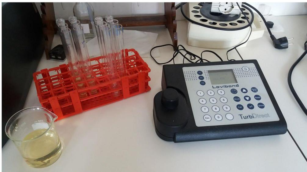
Figura 11. Turbidímetro utilizado para medir a turbidez das amostras de vinho.
