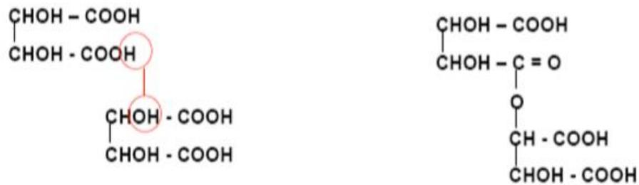
Figura 6. Esterificação do ácido tartárico que dá origem ao ácido metatartárico (Morello, 2012).
