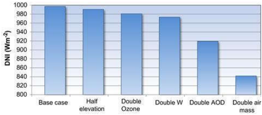
FIGURA 2.30 - COMPARAÇÃO DO IMPACTO NO DNI NUM DIA DE CÉU LIMPO COM SITUAÇÕES EM QUE OCORRE O DOBRO DE AOD, O DOBRO DE VAPOR DE ÁGUA, O DOBRO DO OZONO, O DOBRO DA MASSA DE AR E UMA REDUÇÃO DA ALTURA DO SOLO EM 50%, TENDO COMO CASO BASE UMA MASSA DE AR DE 1.5, 1100M ALTURA, AOD = 0.03, VAPOR DE ÁGUA = 0.75CM, E OZONO = 320 DU, [17].
