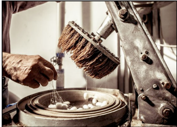
Image 26. Système de tirage avec un balai mécanique. Archive Seta Etica -Filanda Dorica (2016)
