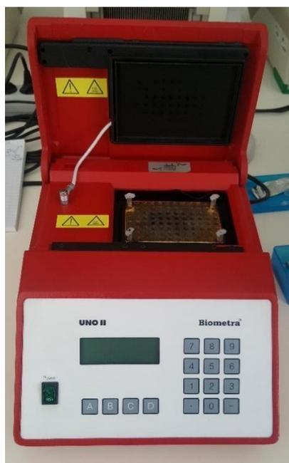
**Figura 13 - Termociclador de tampa aquecida UNO II (Biometra) utilizado no RT-PCR**
