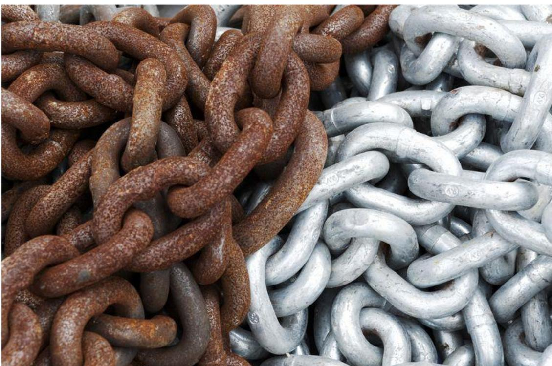
*Figura 35 - Contraste entre o ferro oxidado e não oxidado*
