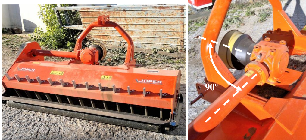
Carter de engrenagem cónica, com lubrificação num destroçador de ramas de poda
