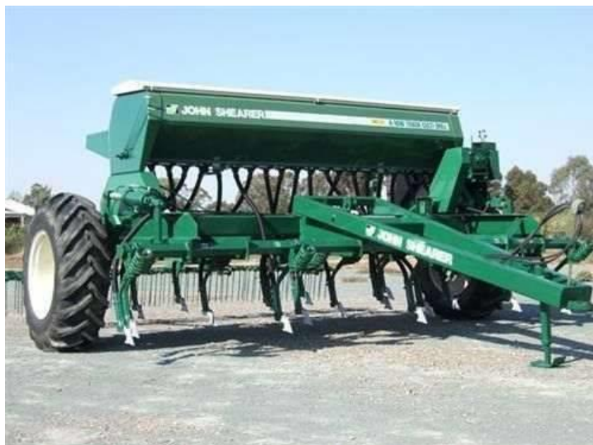
Fig. 1 – Semeador de sementeira directa John Shearer
