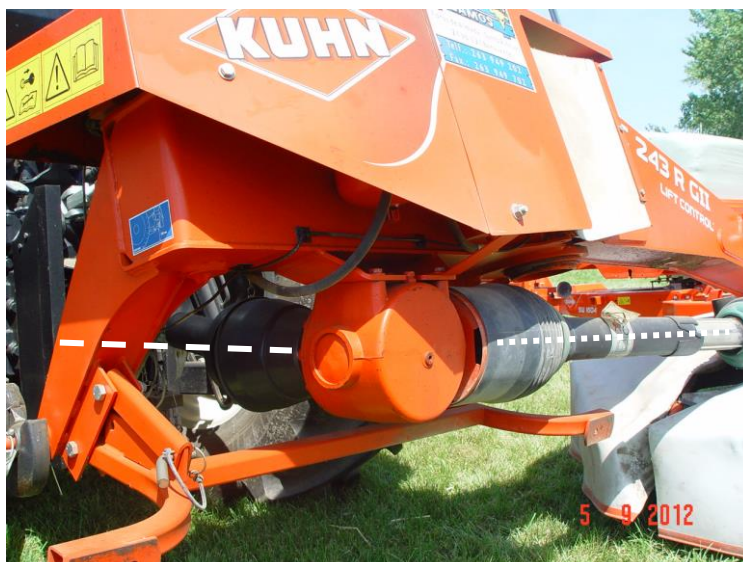
Carter de engrenagem cónica, com lubrificação numa gadanheira
