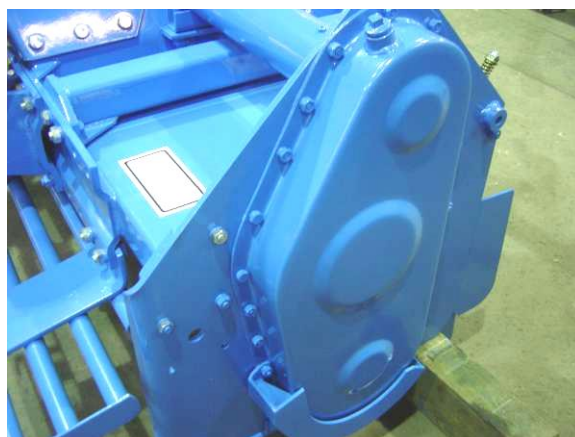
Carter de engrenagem paralela, com lubrificação
