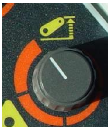
Comando de limite de altura máxima no tractor Massey Ferguson 5465 usado nas aulas de 2009/10
