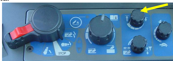
Comando de limite de altura máxima no tractor Fendt 211F
