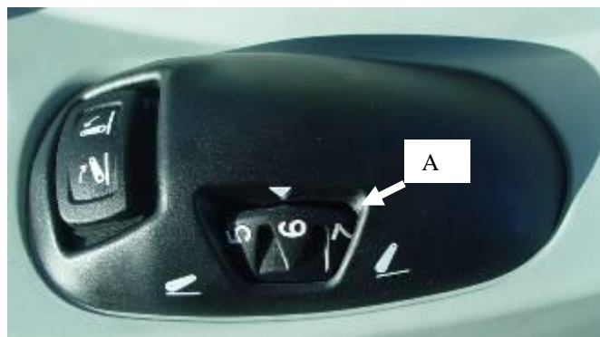
Comando de Posição / Profundidade do tractor Massey Ferguson 5465 usado nas aulas de 2009/10
