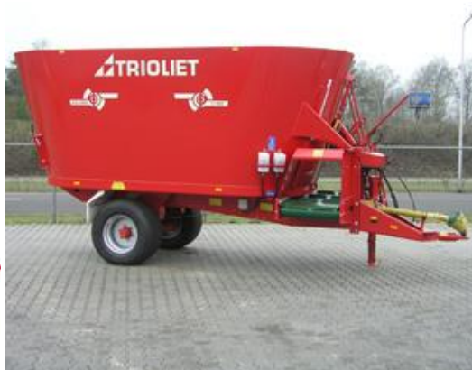
Previsto para barra-de-puxo ou boca-de-lobo
