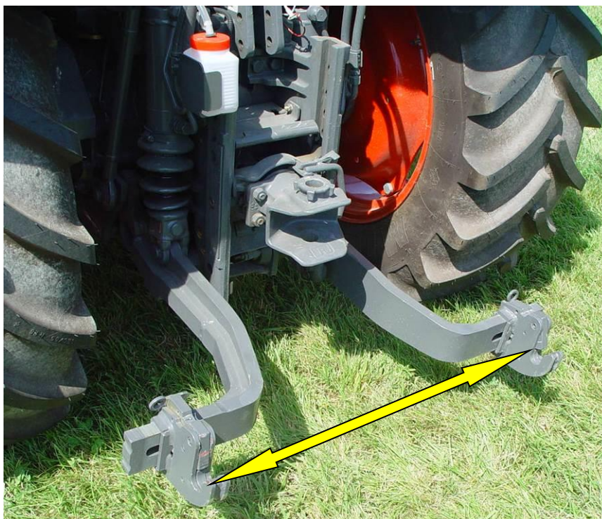
Braços inferiores do tractor Fendt 211F
