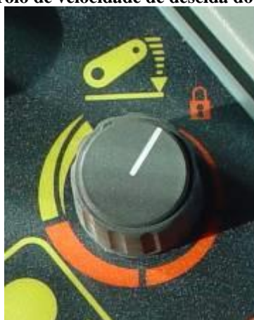
Comando de controlo de velocidade de descida do tractor Massey Ferguson 5465
