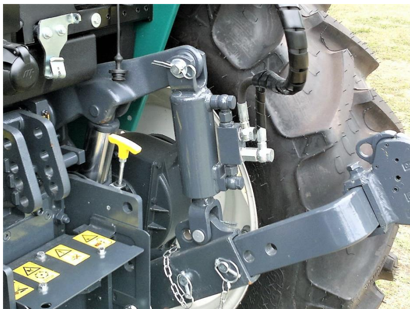
Cilindro hidráulico de duplo efeito servindo de pendural direito
