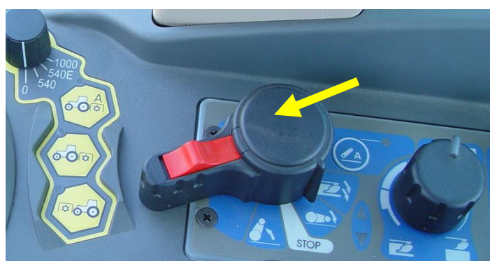
Comando rápido de subida e descida do tractor Fendt 211F
