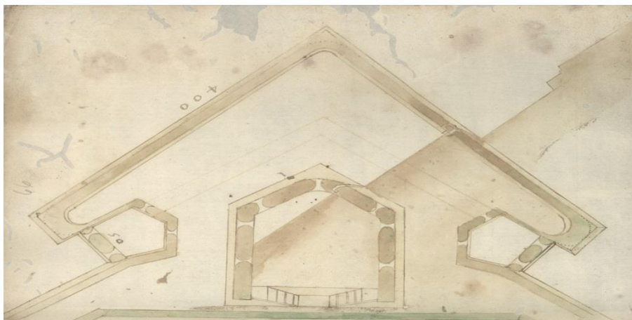
Fig. 1 – Terrapleno de um baluarte desenhado por António Rodrigues no Tratado de Arquitectura , 1575-1576
