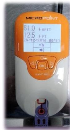
**Figura 24** | Aparelho analisador portátil dos tempos de coagulação utilizado no HVPT (Imagem de autora).
