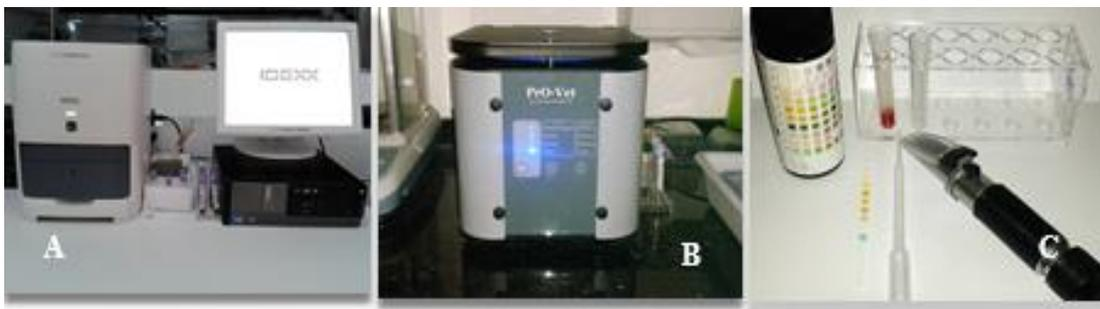
**Figura 3|** Equipamento e materiais usados para realização de análises bioquímicas, centrifugação de fluídos e urianálise - (A) analisador bioquímico IDEXX Catalyst® One™, (B) Centrífuga Pro-Vet® e (C) Refractómetro e tiras reativas de urina (Cortesia de HVPT).
