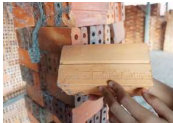
Figure 19. Brique terminée avec logo de la briqueterie. Source : Auteur.
