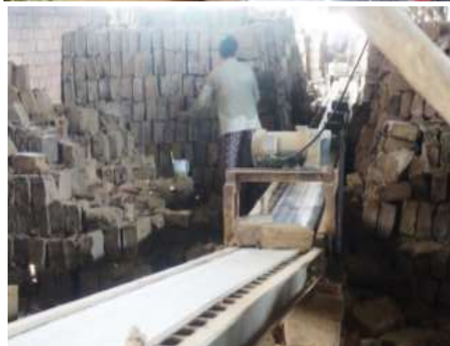
Figure 16. L'argile est préalablement transformée en blocs rectangulaires. Source :Auteur
