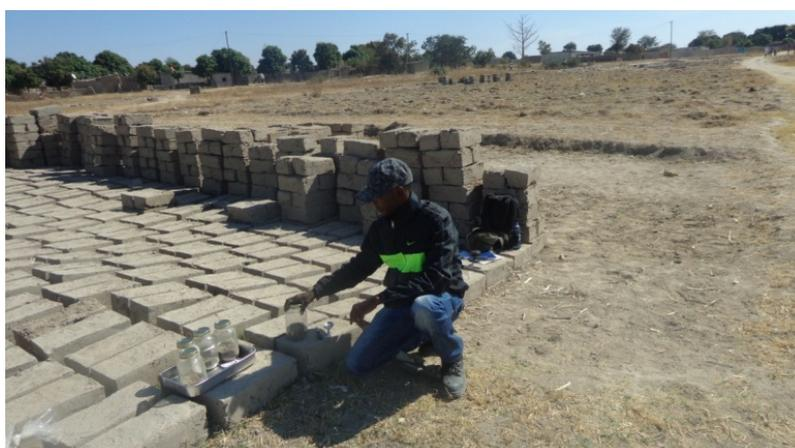
**Figura 3** - Realização de ensaios *in-situ*: Ensaio de sedimentação “Teste da garrafa”.
