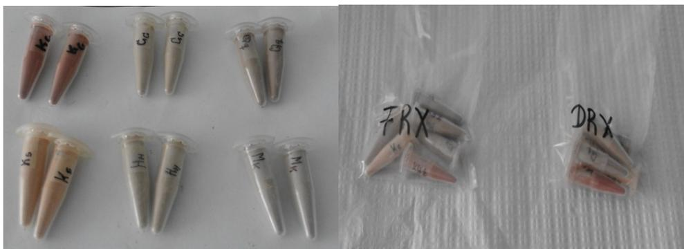
**Figura 4.12** – Provetes de solos a serem ensaiados para a análise de fluorescência de raios-X (FRX) e de difração de raios-X (DRX). Fonte: Fotografia de Wachilala.
