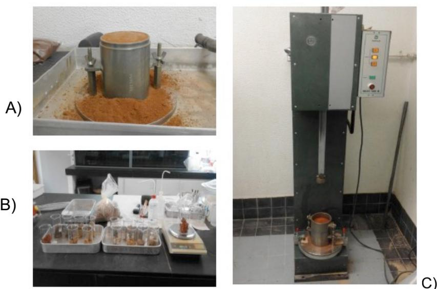
Figura 4.16 - Ensaio de compactação tipo Proctor: A) Molde pequeno com o solo compactado; B) Pesagem dos provetes de solos; C) Equipamento de compactação mecânica. Fonte: Fotografia de Wachilala.
