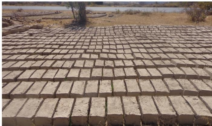
**Figura 2.24** – Secagem ao ar livre dos blocos de adobes. Fonte: Fotografia de Wachilala.
