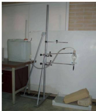
**Figura 4.15** – Sistema experimental do teste de erosão pelo método de Geelong “Geelong Test” (Carvalho, 2008).
