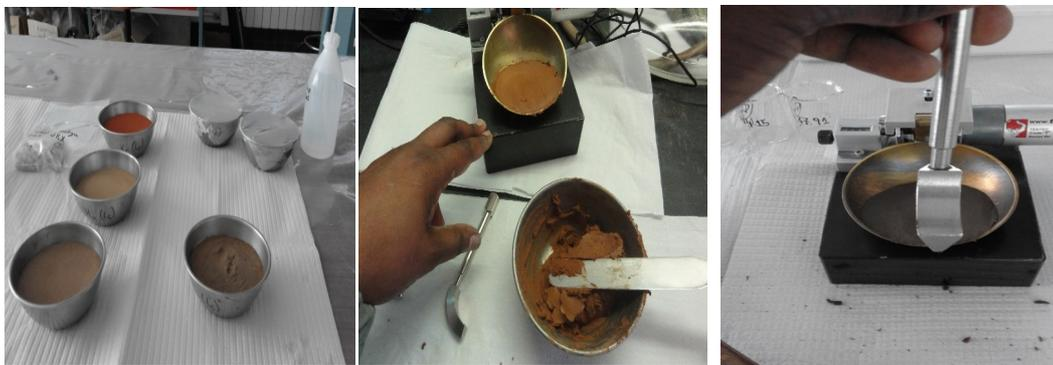
**Figura 4.7** - Determinação dos limites de liquidez dos provetes de solo pelo método da concha de Casagrande. Fonte: Fotografia de Wachilala.
