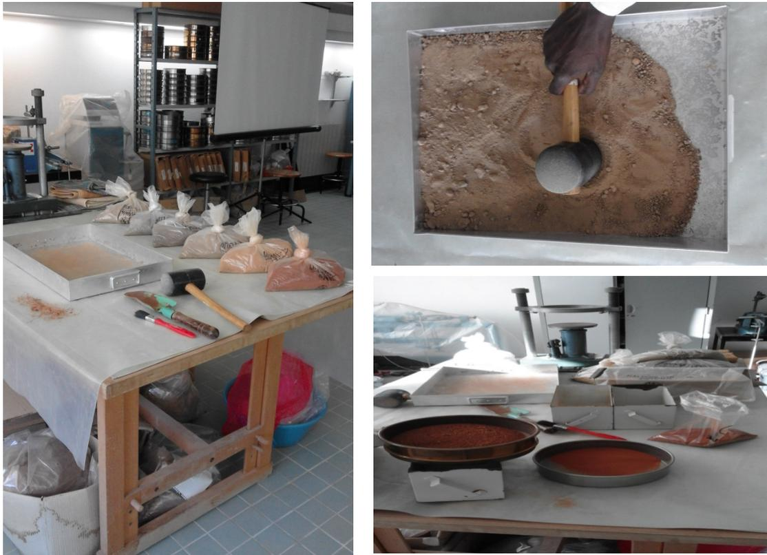
**Figura 4.5** - Preparação geral das amostras de solos no laboratório: (A) Amostras de solo quantificadas; B) Desagregação dos torrões; C) Repartição dos solos. Fonte: Fotografia de Wachilala.
