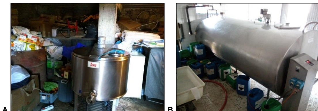
Figura 5- A: Tanque de armazenamento de leite cru em local inadequado. B: Material obsoleto e detritos junto a tanque de armazenamento.
