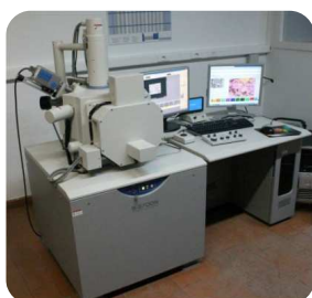
Figura 7: Microscópio eletrónico de varrimento com detetor de EDS.
