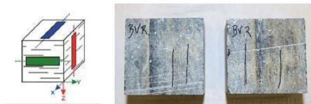
Figura 1. (A) Esquema mostrando a foliação e as direcções preferenciais para a obtenção de provetes para o ensaio de expansibilidade; (B) Amostras de Ruivina cortadas segundo o corrume.
