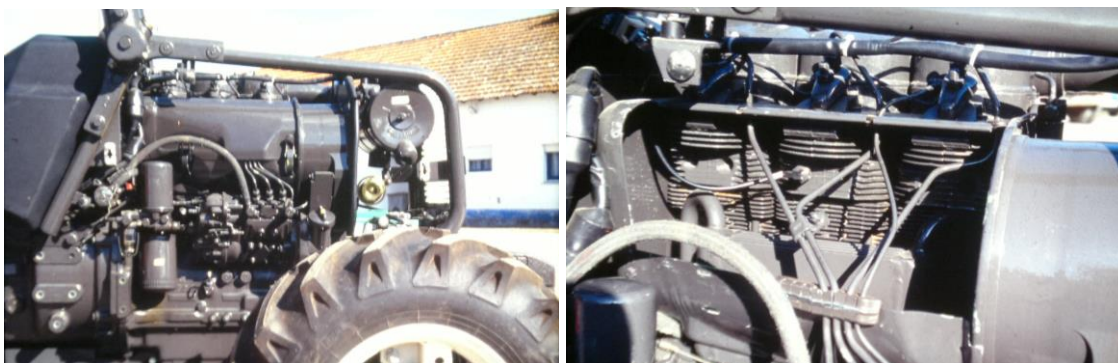
Tractor Carraro 6100F, vendo-se à direita o pormenor das alhetas de arrefecimento da cabeça e cilindros, após ter sido retirada a tampa da caixa de ar.
