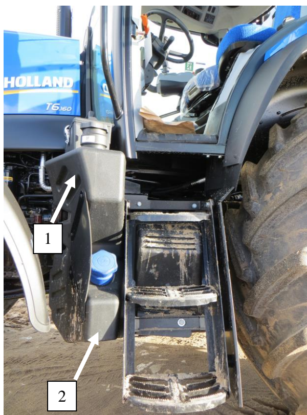
1 – Depósito de combustível; 2 – Depósito de AdBlue®
