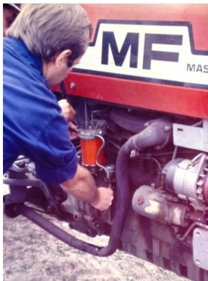
Aluno do COMA a efectuar a purga do ar do sistema de alimentação (accionando a patilha da bomba de alimentação e mantendo aberto o orifício de purga no topo do filtro de gasóleo)
