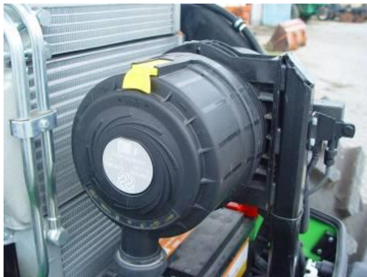
Caixa do filtro de ar do tractor Deutz Agrifarm 420 usado nas aulas em 2009/2010
