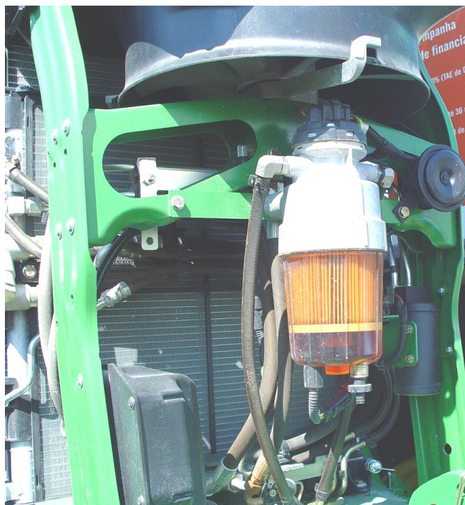
Sistema de filtragem de combustível e separação de água num tractor John Deere
