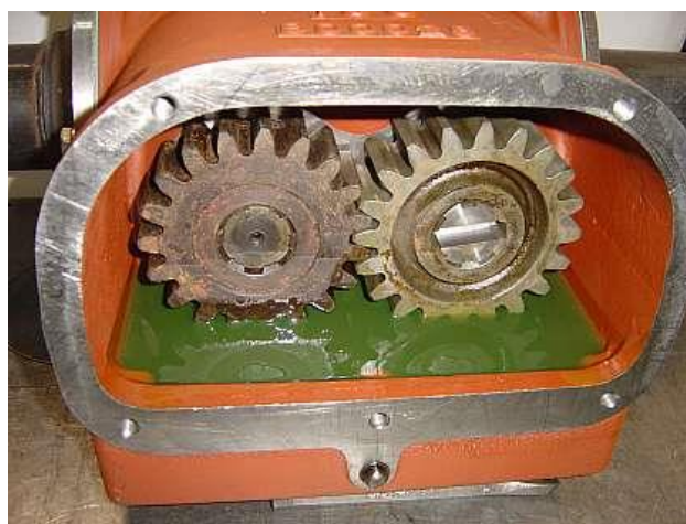
Engrenagem paralela, com dentado recto, em carter com lubrificação
