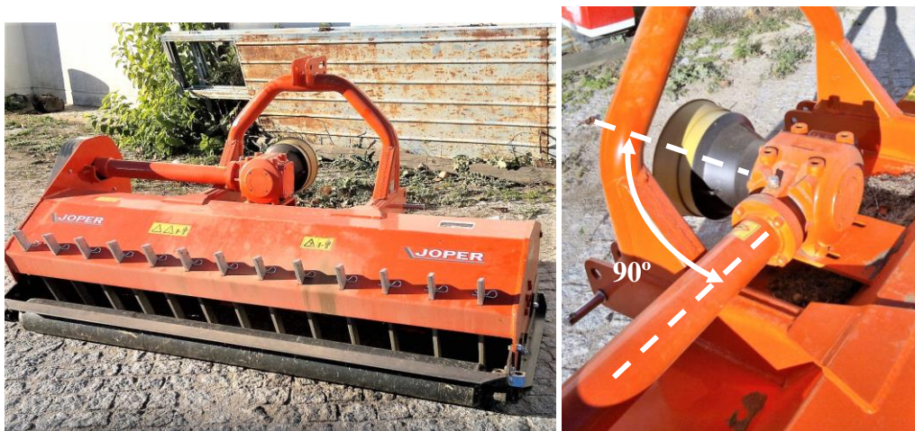
Carter de engrenagem cónica, com lubrificação num destroçador de ramos de poda
