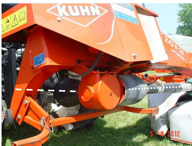
Carter de engrenagem cónica, com lubrificação numa gadanheira
