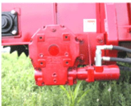
Carter de engrenagem sem-fim, com lubrificação
