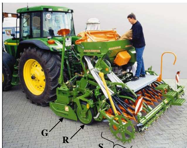
G- Grade rotativa; R – Rolo; S - Semeador Ver funcionamento deste tipo de semeador em: http://info.amazone.de/DisplayFLV.aspx?id=6162
