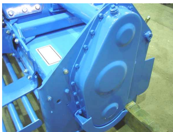
Carter de engrenagem paralela, com lubrificação
