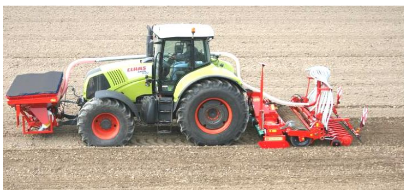
À frente: tremonha; ventilador; doseador. Atrás: grade rotativa; rolo; repartidor; corpos do semeador.
