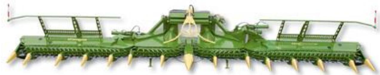
A toda a largura, do lado direito e do lado esquerdo da cabeça, existem correntes de transporte (*endless collectors*), deslocando-se em sentidos contrários, por forma a transportarem para o centro da cabeça as plantas. Estas foram cortadas, pela base, por uma corrente de facas que está colocada por debaixo das correntes de transporte
