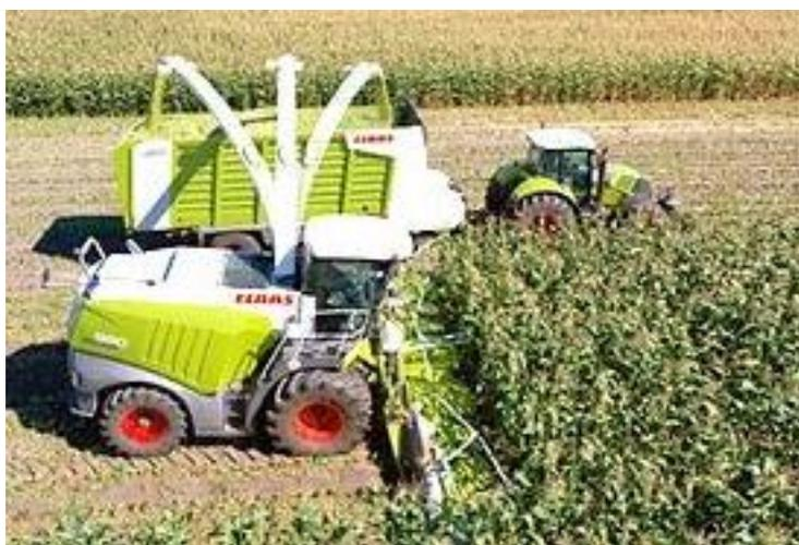
Accionando o comando do Sistema na cabina, o operador vê o tubo de descarga a mover-se para a posição correcta e pode seguir num monitor a operação de enchimento.
