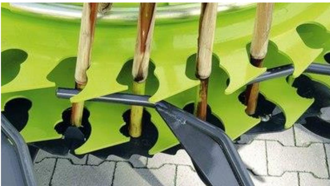
Cada disco rotor corta e alimenta 2 linhas de milho. As plantas cortadas são dirigidas por 4 passagens (*passageways*) para o sem-fim de alimentação (*feed auger*). Este fluxo é auxiliado por diversos rotores de encaminhamento (*clear-out disc / reversing drums*).
