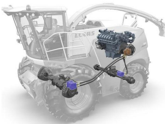
A transmissão para os dois eixos é hidrostática (*Hydrostatic transmission*). O motor Diesel está ligado directamente à bomba de óleo da transmissão hidrostática. A bomba é do tipo bomba de êmbolos de débito variável, conhecida pela sua designação inglesa *Swashplate pump*. Nestas bombas, é possível variar o caudal sem alterar a velocidade de rotação, isto é sem que seja necessário alterar a velocidade de rotação do motor Diesel que impulsiona a bomba.
