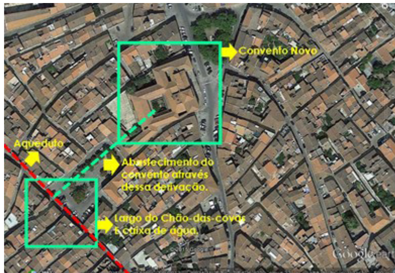
Fig. 58 – Planta esquemática mostrando o aqueduto e a sua ligação ao Convento de S. José da Esperança.
