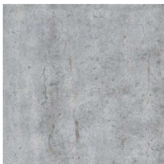
fig. 224 Betão Afagado. Pavimentos Interiores
