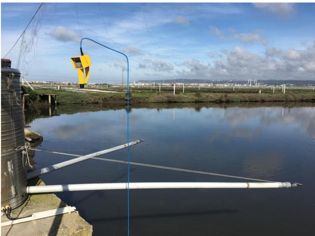
**Figura 17 – Alimentador automático e oxímetro [fotografia original]**
