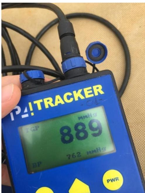
Figura 30 – Aparelho de medição da saturação de gases [fotografia original]
