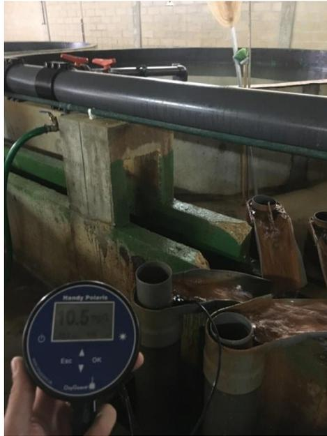
Figura 28 – Medição do OD na água de saída de um tanque [fotografia original]
