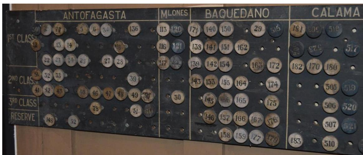
*Système permettant de figurer l'emplacement et la distribution des wagons, numérotés*
