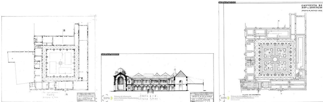
Fig. 4.11 - Da esquerda para a direita: Planta e Corte da DGEMN datados de 1960, ao centro corte referente à mesma planta, à direita Planta do projecto de adaptação a Museu (curiosamente esta planta apresenta a quadripartição do pátio e o poço circular, que não chegou a ser executado).
