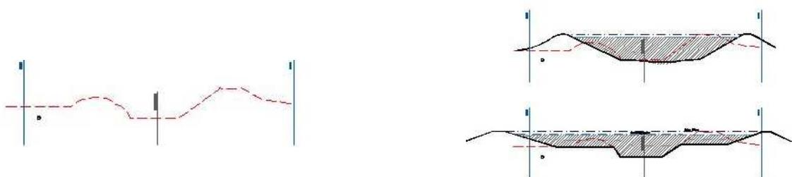
Fig. 1.42 – Imagem, à esquerda, do perfil existente - situação de referência  $Q = 22 \text{ m}^3\text{s}^{-1}$  ( $Tr \approx 1,5$  anos); à direita, em cima, perfil simples (fase de anteprojecto); à direita, em baixo: perfil composto (opção seleccionada) - área da secção de vazão igual em ambos os perfis,  $Q = 114 \text{ m}^3\text{s}^{-1}$  ( $Tr = 10$  anos). (S/Esc.).
