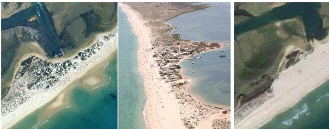
Fig. 1.4 – Histórico das alterações morfológicas da ilha da Fuseta (“Google Earth”). Imagem à esquerda: Out.2006; ao centro– fotografia aérea de 2007, cedida pela Junta de freguesia da Fuzeta; à direita – Maio 2011, após a ruptura e a abertura da barra foi efectuado assoreamento artificial, visível na fotografia.
