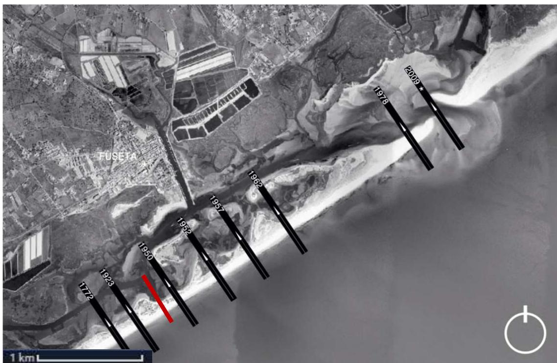
Fig. 1.3 - Esquema de evolução da barra da Fuzeta. A vermelho o local de ruptura em 2010.
