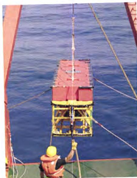
**Figura 2.36** – Fotografia tirada durante a manobras de colocação na água da plataforma do sonar TOBI; durante a campanha HITS'01 a bordo do navio oceanográfico Hespérides.
