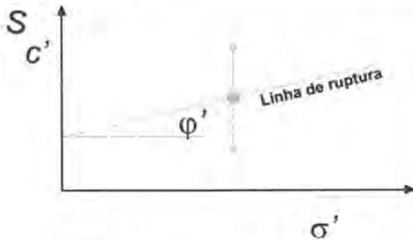
**Figura 4.2** – Linha de ruptura definida pela envolvente de Mohr-Coulomb. Se a circunferência de Mohr para um dado estado de tensão, ficar aquém da envolvente, o material está em equilíbrio; se for tangente à envolvente, então atingiu-se a resistência do material. Não é possível encontrar um estado de tensão em que a circunferência de Mohr intersecte a envolvente, pois antes resultaria a ruptura do material.
