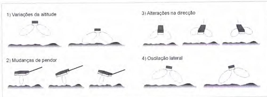
**Figura 2.23** – Variações na posição do aparelho que podem provocar artefactos geométricos. 1) Variações de altitude, normalmente associadas a variações de velocidade do navio ou a variações abruptas do fundo; 2) Mudanças de pendor, resultado das variações de velocidade; 3) Alterações na direcção, causadas pelas mudanças de direcção do navio ou por correntes submarinas fortes; 4) Oscilações laterais, devidas a correntes submarinas ou ao efeito da força centrífuga.
