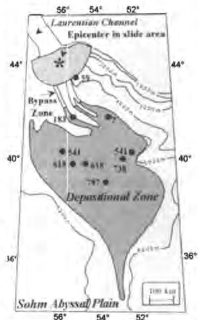
**Figura 4.3** – Esquema da área total afectada pelos depósitos do Grand Banks Slide de 1929. Encontram-se registados os locais onde se deu ruptura dos cabos submarinos e a quantos minutos, após o sismo, se deu a ruptura [Adaptado de Piper *et al.* (1985) in Locat, 2001].
