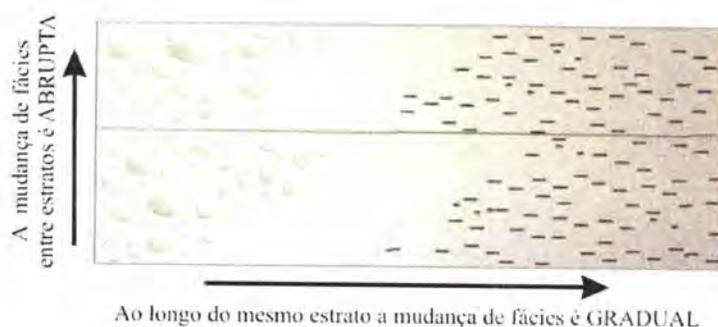
**Figura 2.7** – Os contrastes de impedância acústica são abruptos através dos planos de estratificação e graduais através das fronteiras de fácies dentro do mesmo estrato. Adaptado de Bertram & Milton [1996].
