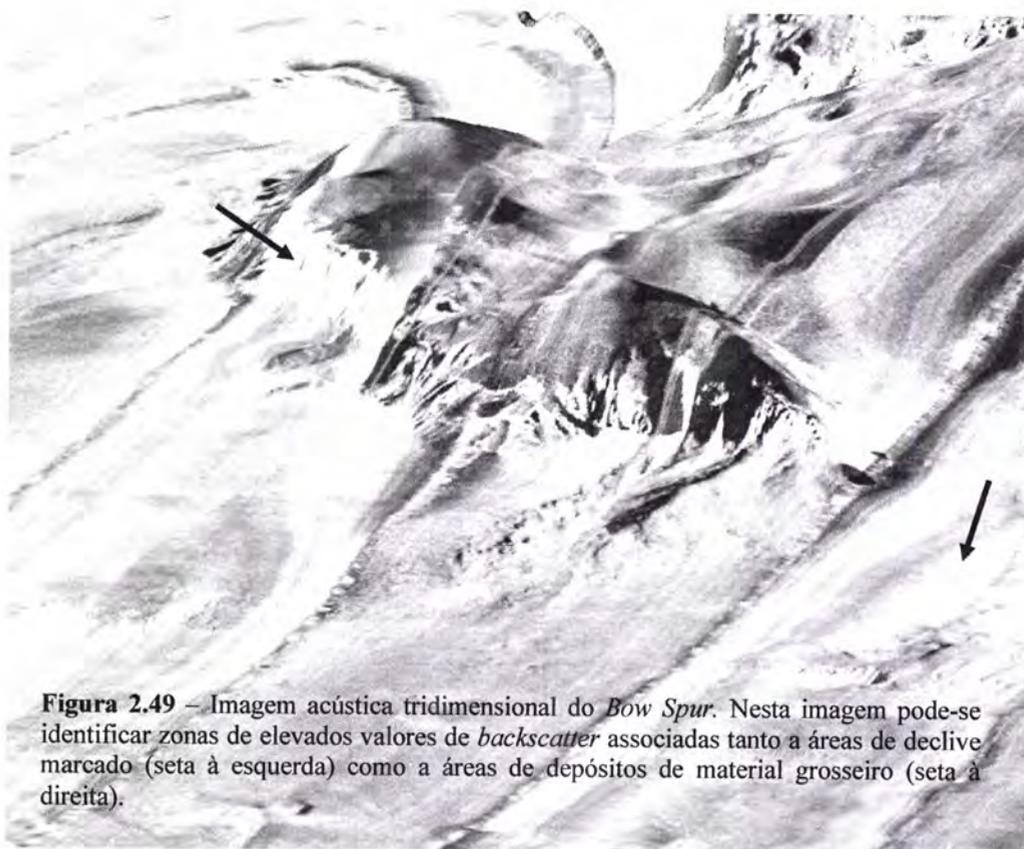
**Figura 2.49** – Imagem acústica tridimensional do *Bow Spur*. Nesta imagem pode-se identificar zonas de elevados valores de *backscatter* associadas tanto a áreas de declive marcado (seta à esquerda) como a áreas de depósitos de material grosseiro (seta à direita).
