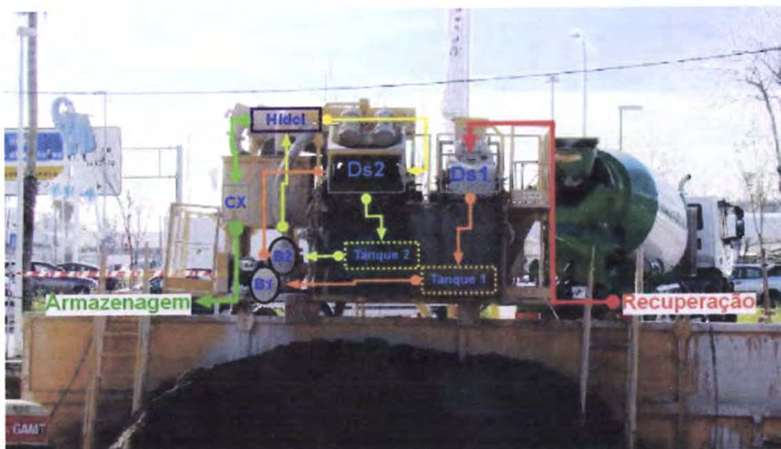
Figura 6.11 - Esquema do circuito de lama num desarenador GOSAG®.
