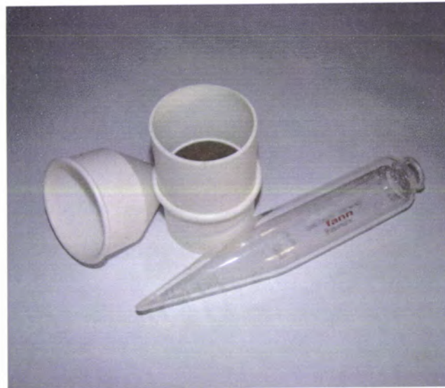
Figura 3.10 – Conjunto de medição do teor de areia.
