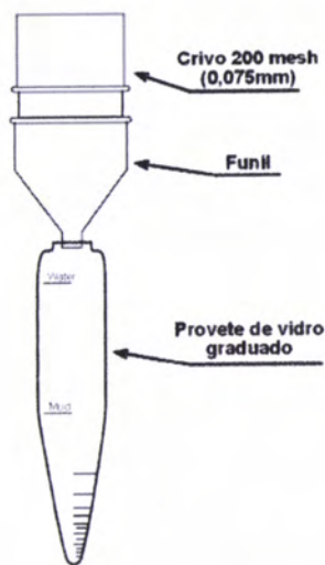
Figura 3.10 – Conjunto de medição do teor de areia.
