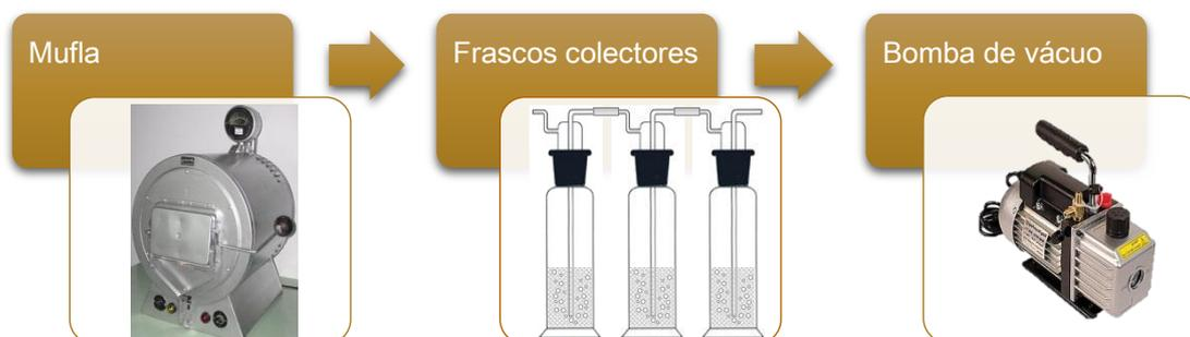
**Figura 30.** Representação esquemática do sistema de combustão e recolha dos componentes do fumo.
