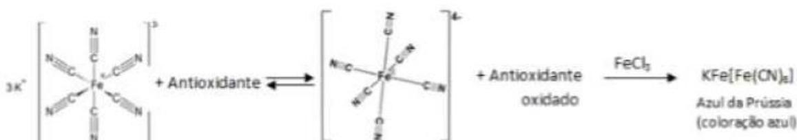
**Figura 24-** Reação de redução do  $\text{Fe}(\text{III})$  a  $\text{Fe}(\text{II})$  na presença de substâncias antioxidantes (adaptado de Berker at al, 2007).
