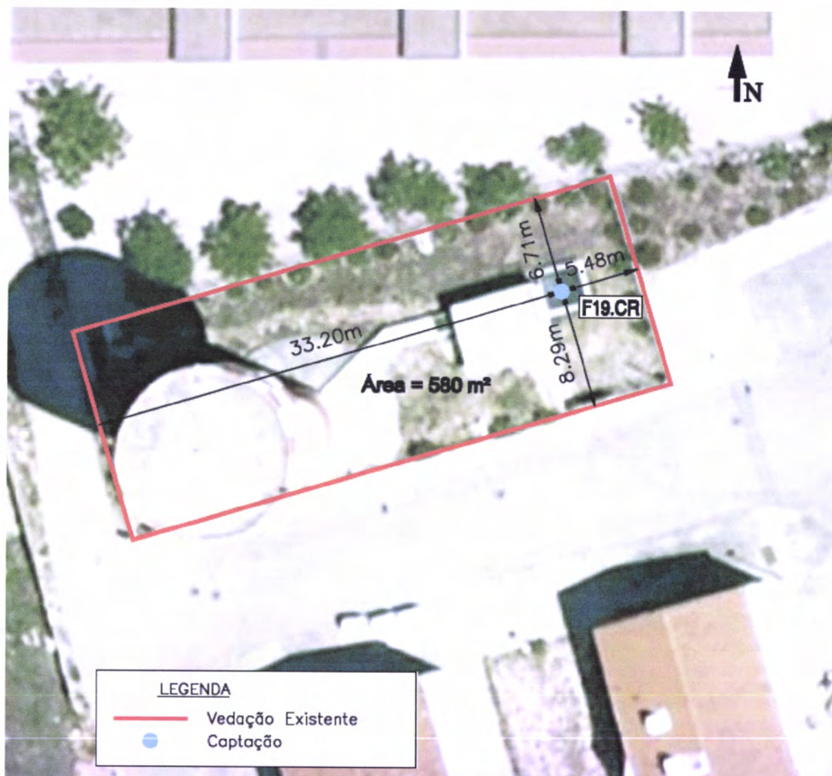
Figura 68 - Implantação da ZPi da captação F19 (Sistema de Abastecimento Público de Montijo)
