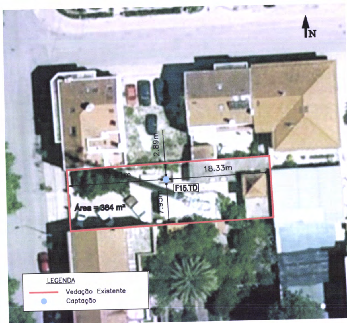
Figura 72 - Implantação da ZPi da captação F15 (Sistema de Abastecimento Público de Montijo).
