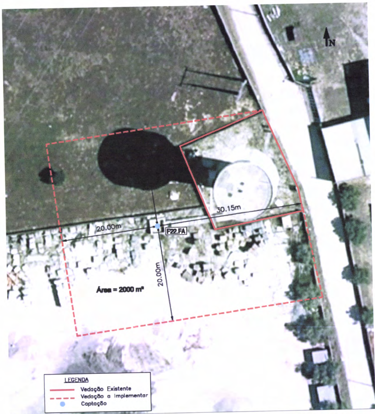
Figura 73 - Implantação da ZPi da captação F22 (Sistema de Abastecimento Público de Pau-Queimado).
