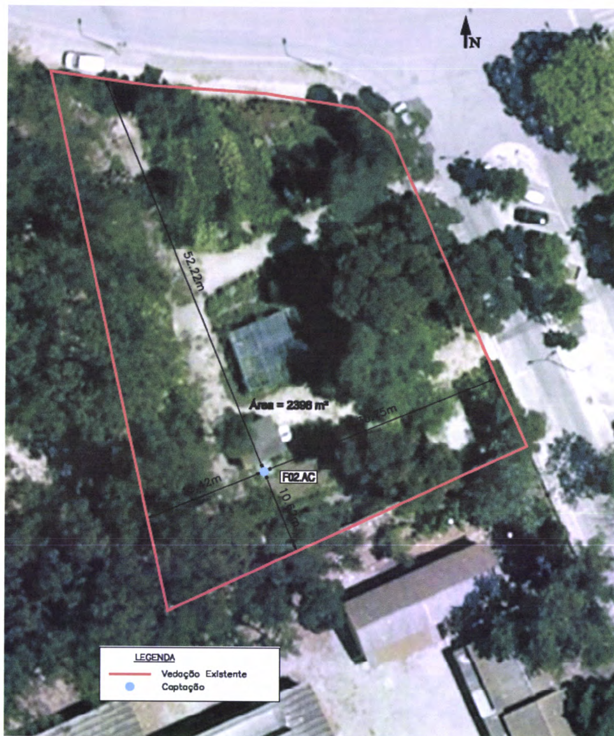
Figura 71 - Implantação da ZPi da captação F2 (Sistema de Abastecimento Público de Montijo).
