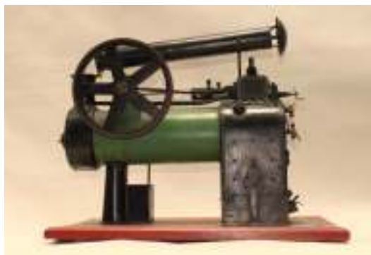
Figura 4: Máquina a vapor. Modelo funcional (1916)
