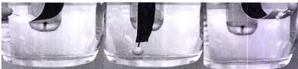
**Figura 2.42** - Movimento de um músculo artificial de bicamada polipirrol/isolador, que move um corpo de 1g num movimento de  $180^\circ$ , demorando cada ciclo 9 segundos (Otero *et al.*, 1998).
