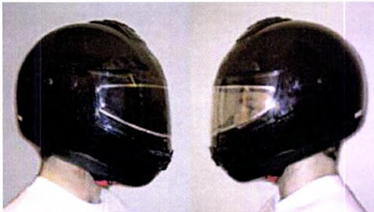
**Figura 2.30** - Capacete de motociclista com materiais electrocrómicos sólidos. O material electrocrómico primário é o  $WO_3$  e o material secundário  $NiO_x$ . À esquerda, o visor electrocrómico está electroactivado e à direita não (Adaptado de Monk *et al.*, 2007).
