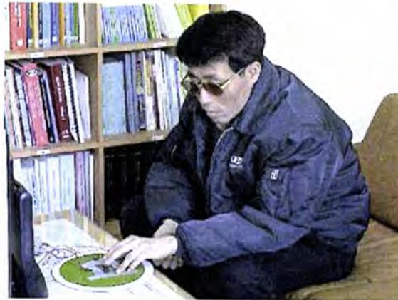
**Figura 2.68** - Uma pessoa invisual a utilizar um sistema Braille baseado num elastómero dieléctrico EAP, desenvolvido na Universidade Sungkyunkwan por Choi. ( Bar-Cohen, 2009)
