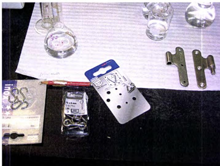
**Figura 3.8** - Material de fácil aquisição, em aço inoxidável, que se pode utilizar como substrato para electrodepositar anodicamente o polipirrol.
