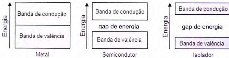
**Figura 2.12** - Comparação dos hiatos energéticos, entre a banda de valência e de condução, de metais, semicondutores e isoladores (Adaptado de Chang, 2005).
