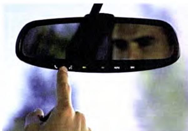
**Figura 2.23** - Retrovisor construído com material electrocrómico. (Adaptado de: <http://www.sc.ehu.es/qpwebem/PRINCIPAL/INDICE/INVESTIGACION/ELLECTROCROMISMO/ECaplicaciones.htm>).
