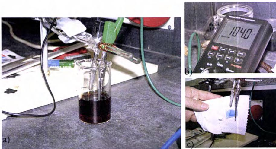
**Figura 3.5** - a) Solução ácida de iões ferro (III) e ferricianeto, onde são introduzidos os eléctrodos; b) Valor da intensidade da corrente aplicada na electrodeposição catódica do azul da Prússia; c) Azul da Prússia electrodepositado no vidro condutor de ITO.
