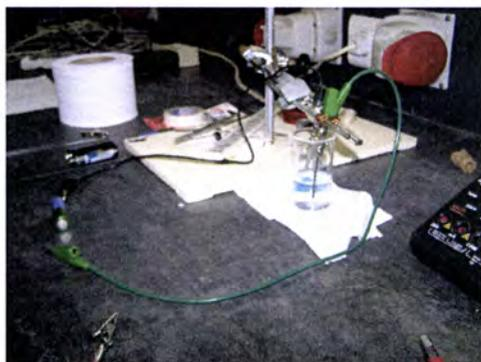
**Figura 3.6** - Circuito elétrico utilizado para observação das propriedades electrocrômicas do Azul da Prússia.
