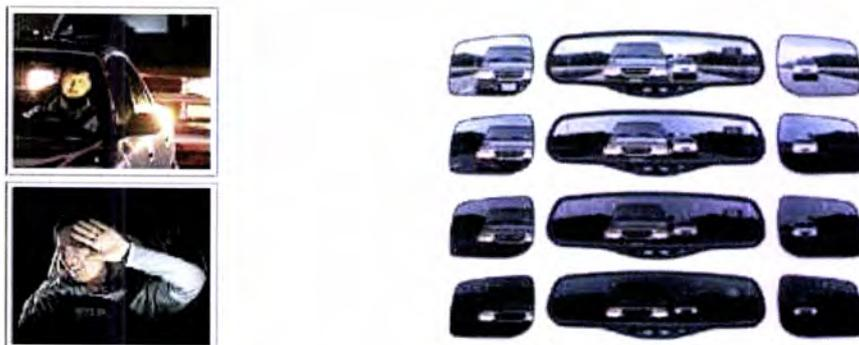
**Figura 2.24** - Nas imagens da esquerda é ilustrado o efeito de encadeamento num retrovisor de um carro. Nas imagens da direita é ilustrado o efeito de um retrovisor electrocrómico em acção. (Adaptado de Miyata, 2007).
