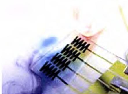
**Figura 2.84** - Libertação sequencial de diferentes substâncias, a partir de um polímero electroactivo que é actuado por valores de d.d.p. pequenos e diferentes (Adaptado de <http://www.mse.ntu.edu.sg/homepages/ma/group-ss.html>).
