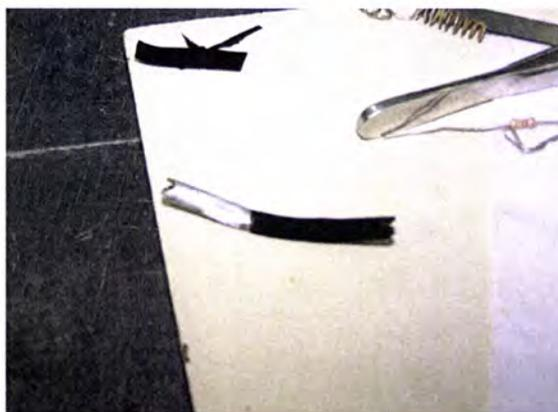
**Figura 3.10** - Polipirrol depositado num gancho de aço inoxidável e pronto a ser retirado para ser utilizado como músculo artificial.
