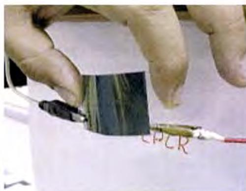
**Figura 2.22** - Dispositivo electrocrómico de 20 cm<sup>2</sup> de área e flexível (Paoli *et al.*, 2002).
