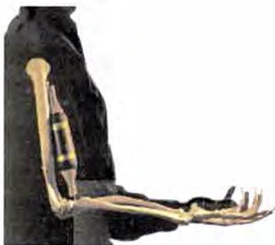
**Figura 2.47** - Modelo de braço robótico, actuado por polímeros electroactivos, que poderá ser usado um dia como prótese articulada. (Ashley, 2003)
