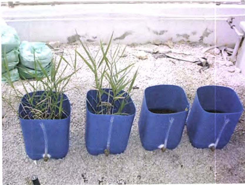
Figura 23 – Leitos construídos de macrófitas de fluxo sub-superficial utilizados no trabalho
