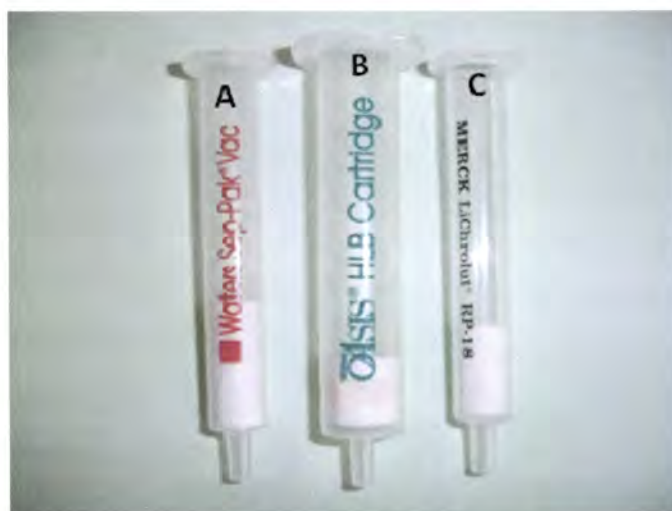
Figura 13 – Colunas de SPE utilizadas no trabalho: A) Waters Sep-Pak® Vac, B) Oasis® HLB e C) Merck LiChrolut® RP-18.
