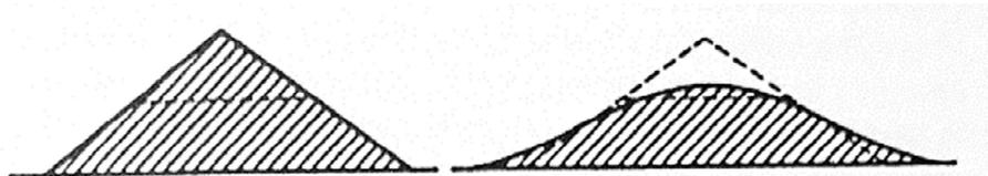
Figura – 10.3 – Esquema de arredondamento da forma da escombreyra (fonte: ITGE, 1989)
