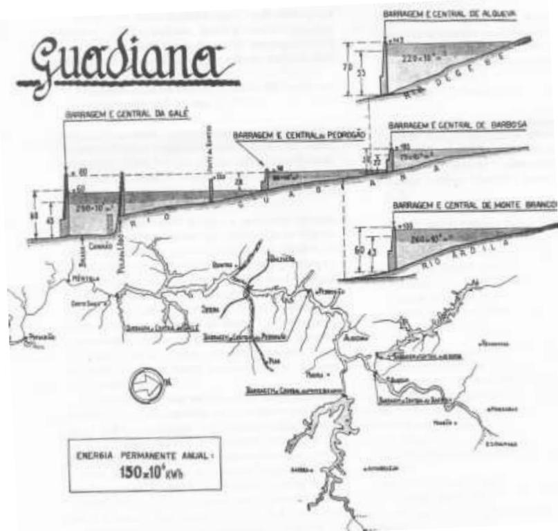
Fig. 1.2 – Aproveitamento do Guadiana e Afluentes, preconizado em 1945 por Carvalho Xerez (Fonte: PINTO, 2003: 61)
