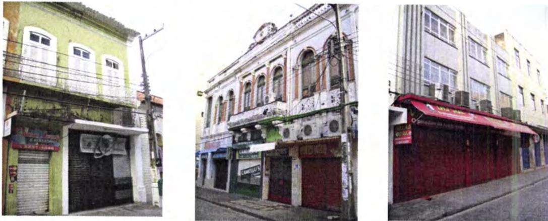
Figura 7-35: São Luís. Rua Grande. Exemplos de edificações com instalações de ar-condicionados descaracterizando as fachadas, além de aberturas inadequadas de vãos nos pisos térreos e uso de cores e engenhos publicitários inadequados, 2009.
