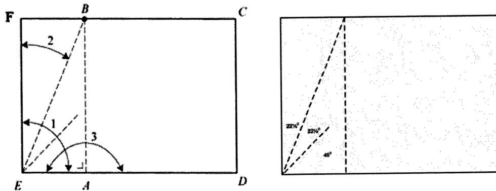
Figura 4-2 - Quadrado obtido a partir de rectângulo sem deixar marca
