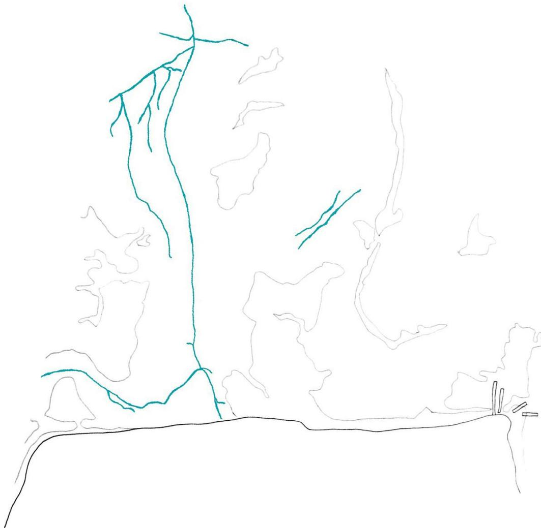
Primeira possível localização do cais no começo da sua construção. A altura do muro de terra onde foi construído veio a exigir um posterior deslocamento do cais. Planta desenhada com base em relatos de pescadores do cais da Carrasqueira
