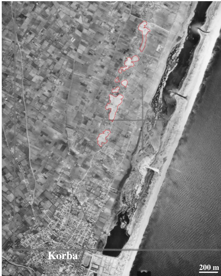
Figure 36: Photo aérienne de la mission de 1989 couvrant une partie du cordon littoral au niveau de la sortie nord de la ville de Korba. Les carrières en activité, marquées en rouge, sont déjà nombreuses et leur taille prend de l'importance ; certaines ont une logueur plurihectométrique. À côté, un extrait de la carte topographique de Menzel Bou Zelfa (1 : 25 000) publiée en 1988. On peut voir également que les carrières commencent à prendre de l'importance.
