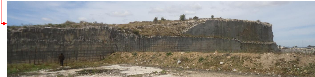
Figures 82: Des traces d'exploitation à la scie mécanique (C. Weslati, août 2014).
