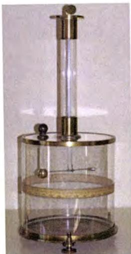
**Fotografia 39.** Balança de Coulomb (Laboratório de Física da ESNA)
