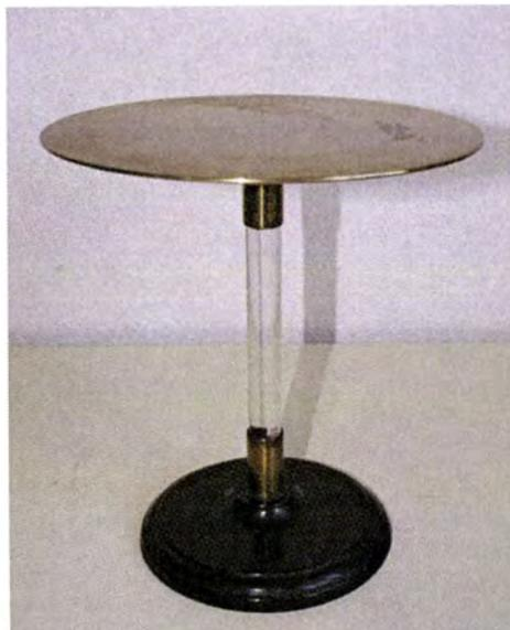
**Fotografia 45.** Prato Electrostático (Laboratório de Física da ESNA)
