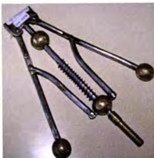
Fotografia 12. Regulador de Watt (Laboratório de Física da ESNA)
