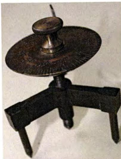
Fotografia 63. Esferómetro (Laboratório de Física da ESNA)
