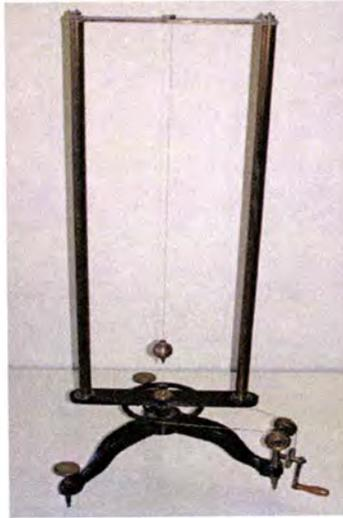
**Fotografia 17.** Pêndulo de Foucault (Laboratório de Física da ESNA)
