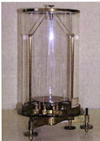
**Fotografia 54.** Galvanómetro de Nobili (Laboratório de Física da ESNA)
