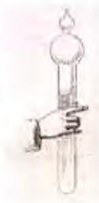
Figura 52. Martelo de água. Ganot, 1859, p.47.
