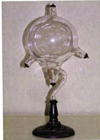
Fotografia 58. Tubo de Crookes (Laboratório de Física da ESNA)
