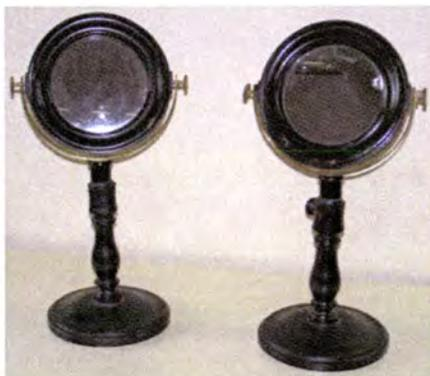
**Fotografia 34.** Par de Espelhos Concavo e Convexo (Laboratório de Física da ESNA)
