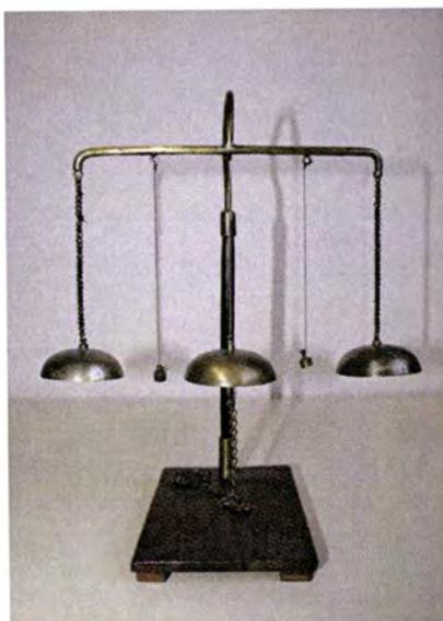
Fotografia 40. Carrilhão electrostático (Laboratório de Física da ESNA)
