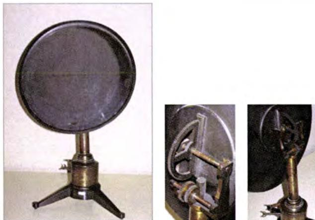
Fotografia 35. Espelho Plano e pormenores (Laboratório de Física da ESNA)
