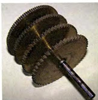
Fotografia 13. Roda de Savart (Laboratório de Física da ESNA)
