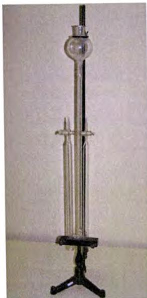
Fotografia 59. Voltâmetro de Hofmann (Laboratório de Física da ESNA)
