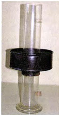
**Fotografia 28.** Aparelho de Hope (Laboratório de Física da ESNA)
