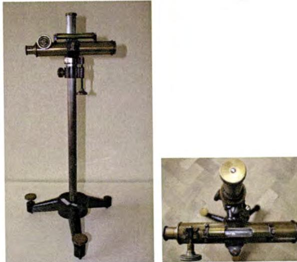
Fotografia 62. Catetómetro (Laboratório de Física da ESNA)
