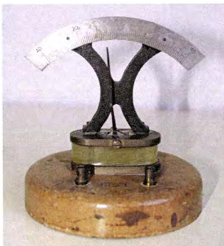
**Fotografia 53.** Galvanómetro de Agulha Vertical (Laboratório de Física da ESNA)
