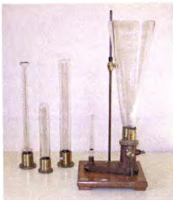
**Fotografia 21.** Aparelho de Haldat (Laboratório de Física da ESNA)
