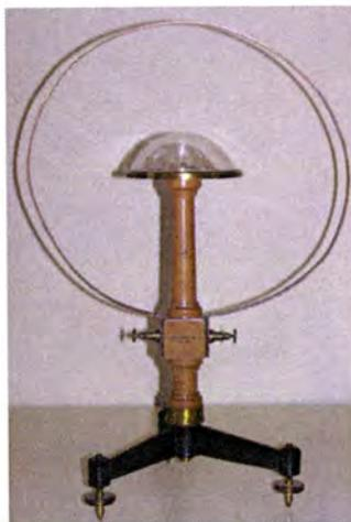
**Fotografia 51.** Bússola de Tangentes (Laboratório de Física da ESNA)
