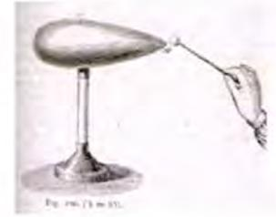
Figura 73. Condutor de forma ovóide.
