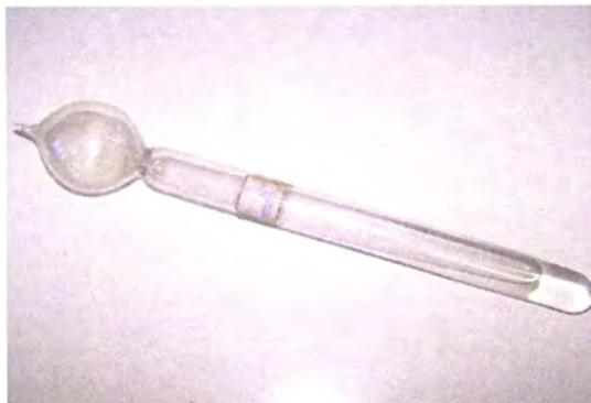
**Fotografia 16.** Martelo de Água Cantante (Laboratório de Física da ESNA).
