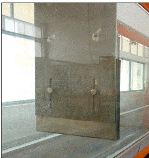
Figura 3.3 - Comporta plana vertical utilizada nos ensaios laboratoriais.
