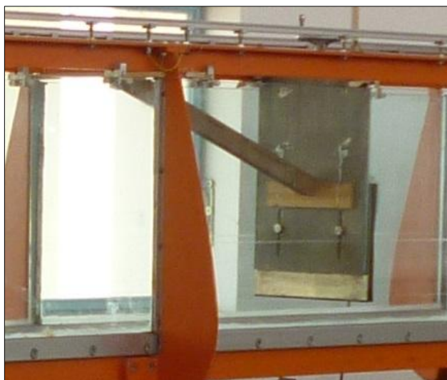
Figura 3.10 - Sistema de reforço aplicado na comporta.
